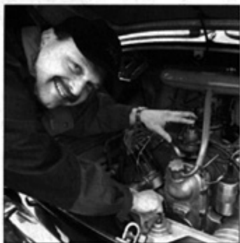
Peter Forker präsentiert stolz das Triebwerk seines Tatra 603-2, Baujahr 64. Der V8-Zylindermotor leistet 105 PS.
